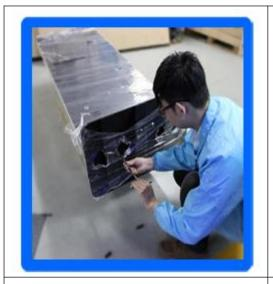
3、将机器底座用内六角螺丝刀把底座用螺丝固定 起来(随机器配送了螺丝和工具);将螺丝拧紧。
